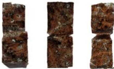
Gambar 11. Bentuk patahan sampel uji impact
