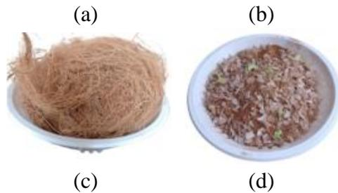
Gambar 3. Bahan utama pembuatan WPC (a) HDPE, (b) Serbuk Gergaji kayu (c) Serat serabut kelapa (d) bahan yang sudah dicampur
