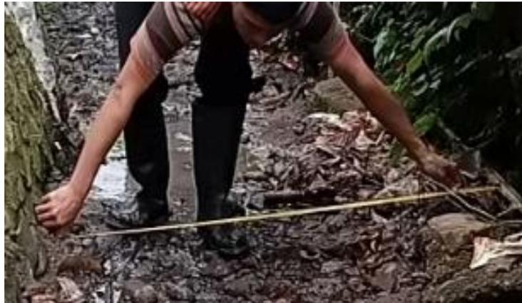
Gambar 7. Foto Pengukuran Lebar Saluran Sungai Menggunakan Meteran Sumber: Foto Sendiri Berlangsung di Lokasi.
