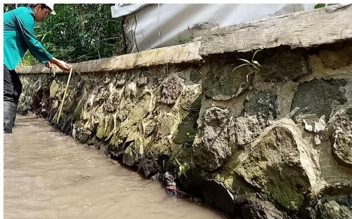
Gambar 3. Pengukuran Tinggi pada Tanggul Saluran Sungai Sumber: Foto Sendiri Berlangsung di Lokasi.
