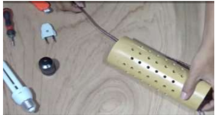
Gambar 5. Pemasangan Kabel dan Lampu
